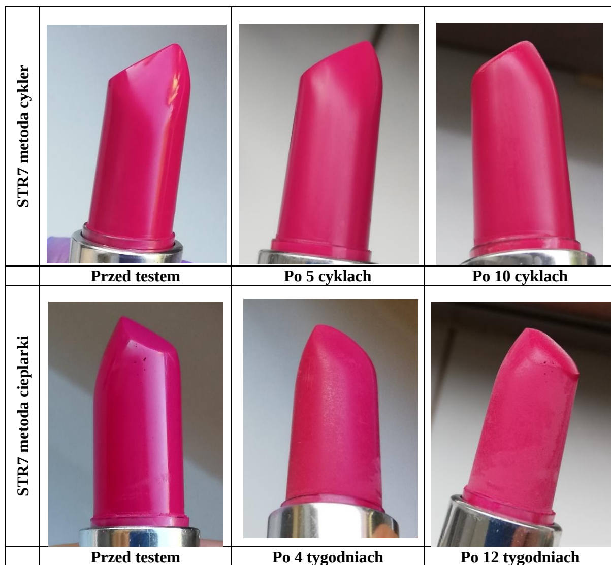
Rysunek 110. Zdjęcia próbki STR7 wykonane mikroskopem HIROX podczas testów starzeniowych m. cieplarki i cyklera
