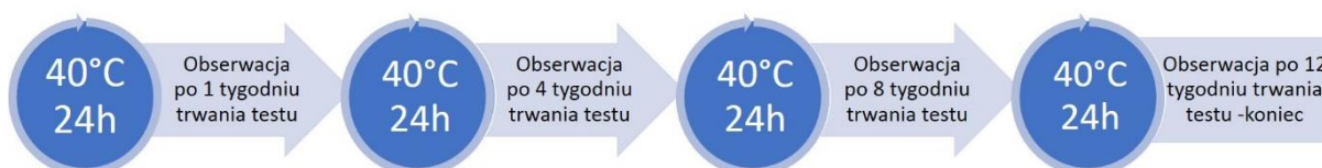
Rysunek 47 Schemat standardowego badania starzeniowego sztyftów (metoda cieplarki)
