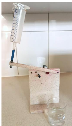
Rysunek 42. Urządzenie do pomiaru wytrzymałości sztyftu na złamanie metodą łamacza
