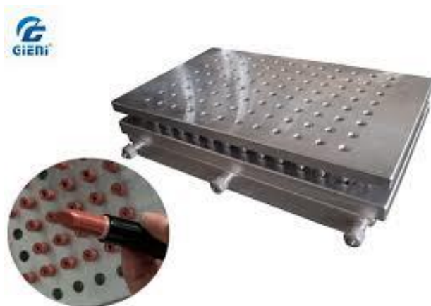
Rysunek 12. Wylewnica do ręcznego konfekcjonowania z 96 gniazdami [Shanghai Gieni Industry Co.,Ltd]
