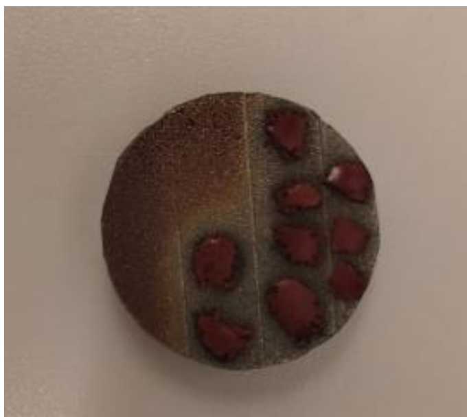
Rysunek 107. Próbkę szminek z dodatkami amfifilowymi po napyleniu złotem
