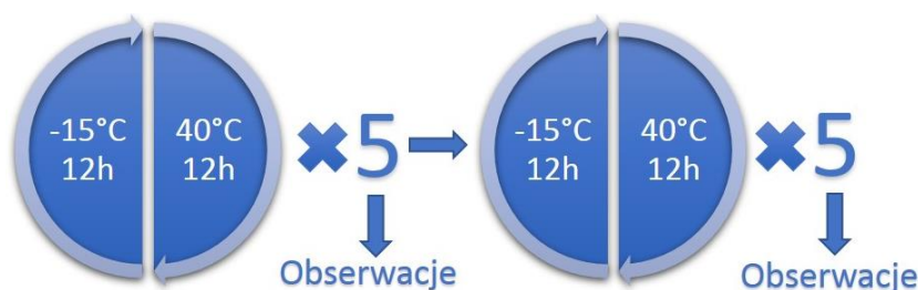
Rysunek 46. Schemat badania próbek metodą przyspieszoną (w cyklerze)
