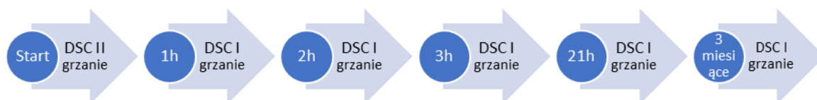
Rysunek 52. Schemat pomiarów DSC obrazujący badania zmian w strukturze szminki w czasie od 1 h do 3 miesięcy od zastygnięcia sztyftu.
